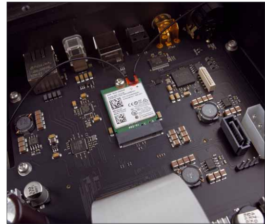
Das WLAN-Modul ermöglicht die Wiedergabe sehr hoch aufgelöster Musik ohne Kabel, auch wenn der Altair dabei ein wenig länger buffern muss
