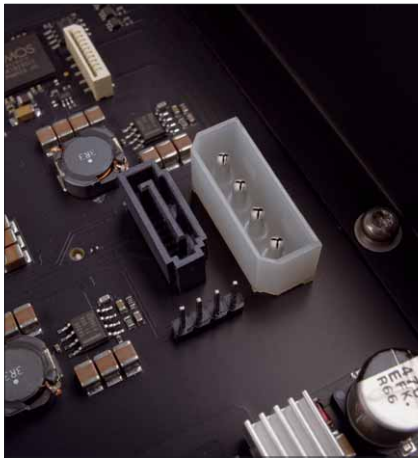
Bei Bedarf kann man den internen SATA-Anschluss nutzen, um den Altair mit dem Einbau einer Festplatte in einen Musikserver zu verwandeln
