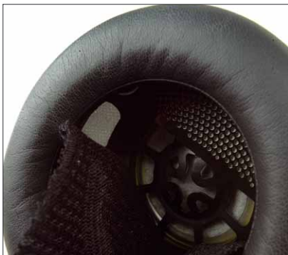
• Der SBESL ist seitlich vor dem dynamischen Treiber montiert
