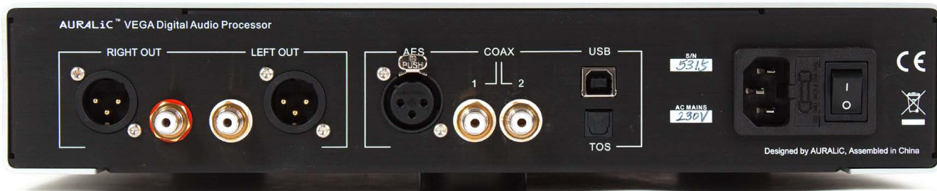
Auf der Rückseite des Vega finden sich sämtliche digitalen Anschlüsse: 1 x XLR (AES/EBU), 2 x Cinch (S/PDIF), 1 x Toslink optisch (S/PDIF), 1 x USB 2.0
