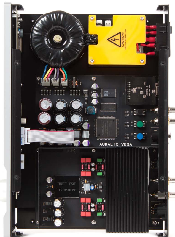
Das Innenleben des Vega: Sein sogenannter Sanctuary Audio-Prozessor basiert auf einer leistungsfähigen Multi-Kern-ARM9-Architektur.
