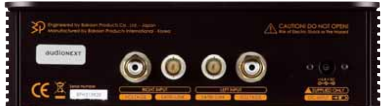
• Die BNC-Buchsen sind die Anschlüsse für die Bakoön-eigenen SATRI-Link Verbindungen
